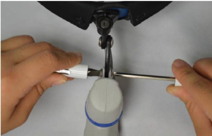
2. Verwenden Sie den Schlitz und den Kreuzschlitzschraubendreher, um die Schraube herauszudrehen.
