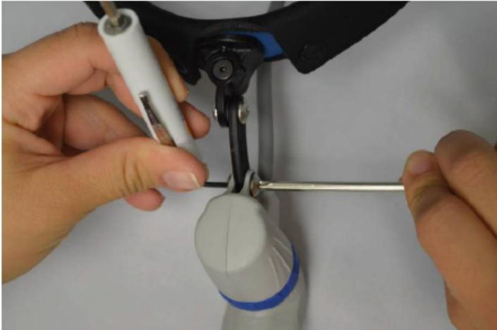
1. Verwenden Sie den Sechskant und den Kreuzschlitz-Schraubendreher, um die Spannschraube zu lösen.
