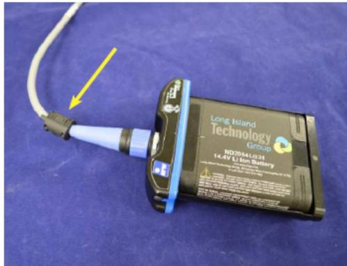
1. Öffnen Sie den mitgelieferten Ferritkern am mittleren Verschluss
