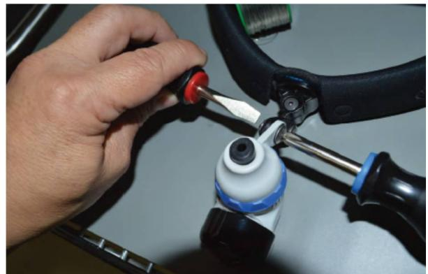
1. Drehen Sie mit dem Inbus die Madenschraube (Schraubensicherung) unter Gegenhalten mit dem Kreuzschraubendreher heraus
