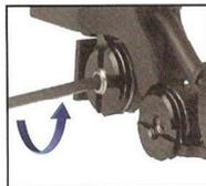
Schritt 3: Ist die Spannung eingestellt, drehen Sie die Stellschraube bis zum Anschlag in die Schraube hinein.
